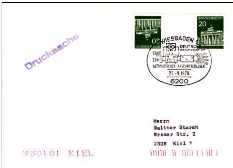
Bild 2: Brief vom Tag der Inbetriebnahme des ersten Anschriftenlesers am 29.09.1978. Fluoreszierende Linearcodierung mit Tintenstrahldrucker mit IKZ (7)9301 und Klarschriftausdruck der Internen Kennzahl 9301 mit dem Zusatz 01 für das Postamt Kiel 1. Der Klarschriftausdruck wurde in der Probezeit und noch einige Wochen nach Inbetriebnahme der Anlage zur Kontrolle auf die Sendungen gedruckt
