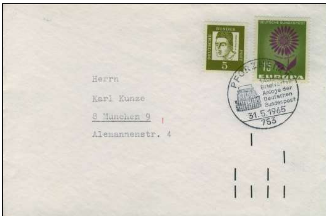
Bild 1: Brief vom Tag der Eröffnung der ersten automatischen Briefverteilanlage der Deutschen Bundespost in Pforzheim am 31.05.1965. Magnetstrich-Codierung mit Interner Kennzahl (IKZ) 0804 für 8000 München 4 (Sammlung des Autors)
