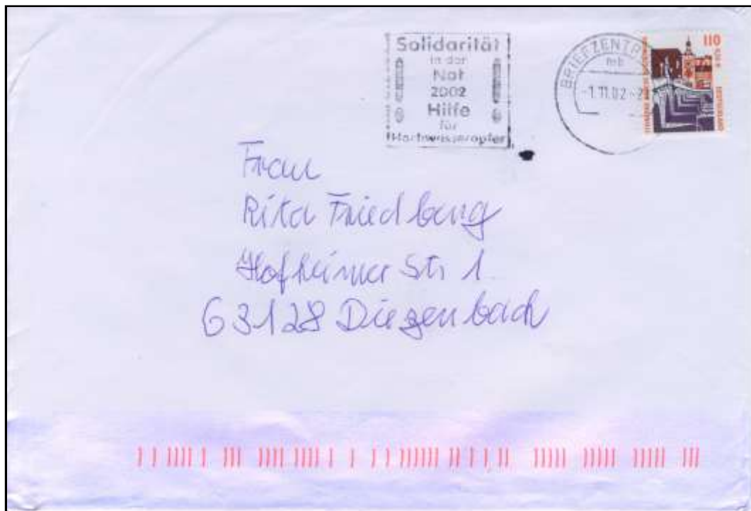
Bild 4: Brief vom 01.11.2002, im heute verwendeten Codeformat 3 vollständig codiert mit (0)63128-077-001 [Postleitzahl mit (Prüfziffer)-Straßennummer-Hausnummer], was zeigt, dass der Anschriftenleser trotz der relativ flotten Handschrift die Anschrift vollständig lesen konnte (Sammlung des Autors)
